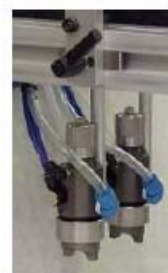
Ein- und/oder Zweidüsensystem
