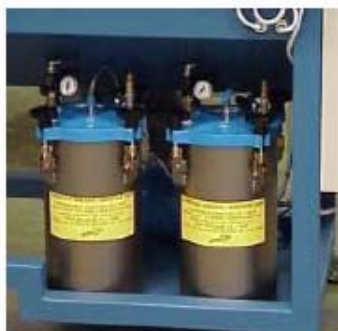
Option: 2ter Tank mit anderem Kleber oder mit Härter
